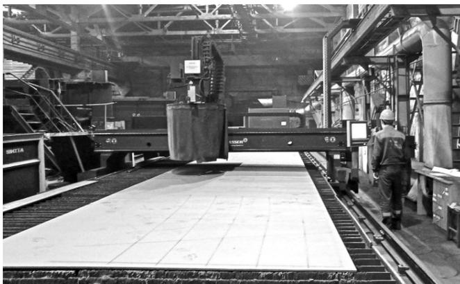
Стол раскроя станка плазменной резки «Мессер»
